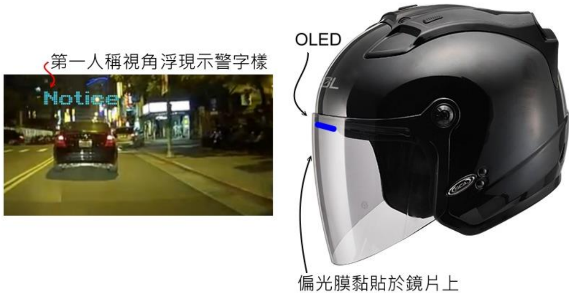
圖 25 抬頭顯示器動作原理
