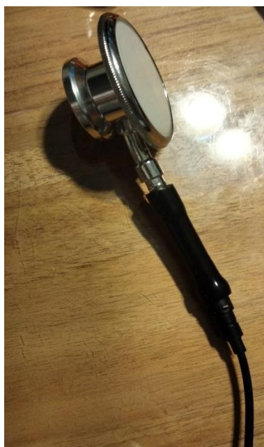
圖 30 聽診器連接麥克風的裝置圖
