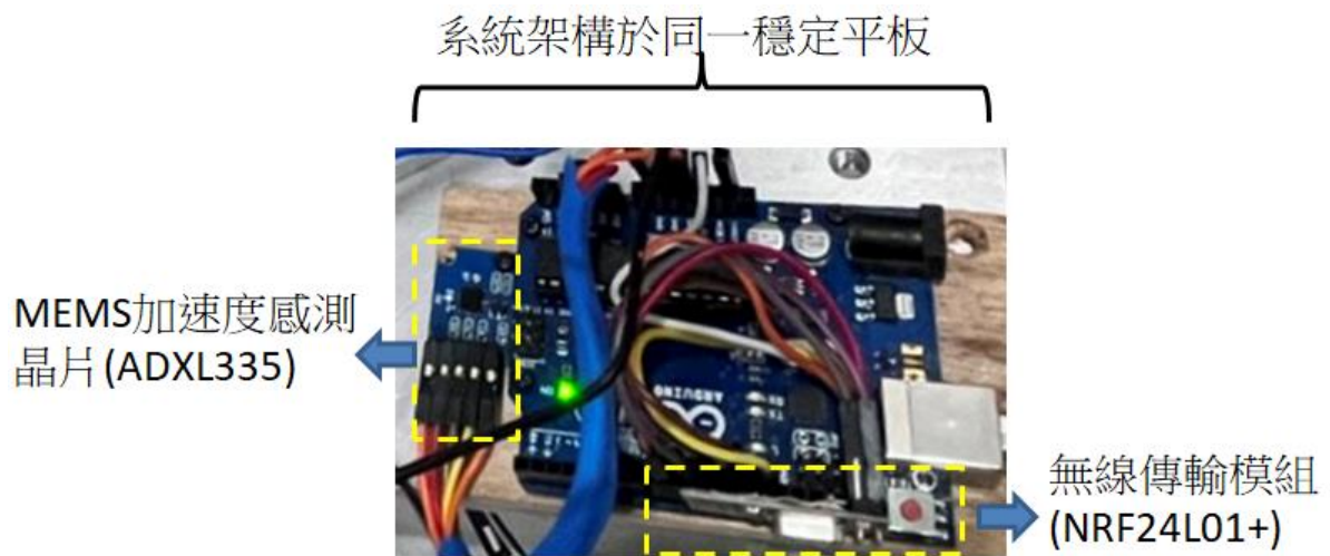
圖 56 加裝無線傳輸模組之加速度感測 Arduino 系統
