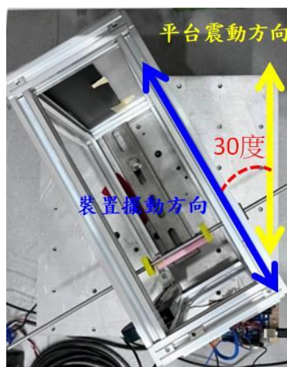
圖 19 光柵繞射單擺測量裝置擺動方向與平台震動方向之夾角
