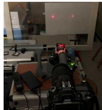
圖 3 光柵片安裝於旋轉平台之實驗架設
