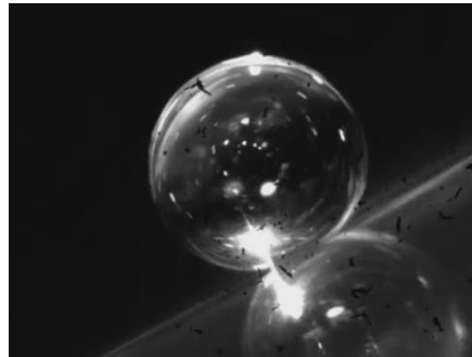
圖 3、本實驗中，顯微鏡鏡頭下的矽油滴，PIV 分析
