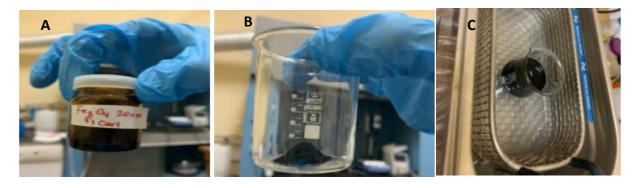
Figure.3.3 a) Fe<sub>3</sub>O<sub>4</sub> NP, b) 200 mg CNT-COOH c) CNT-COOH ve Fe<sub>3</sub>O<sub>4</sub> NP in Ultrasonic bath
