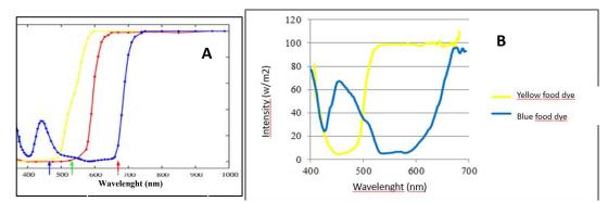
**Figure.4.3** a) Spectrums of yellow blue and red food dyes. (Cleyet, 2005), b) Projede yapıl an spektrometrede farklı renklerdeki gıda boyalarının verdiği spektrumlar.
