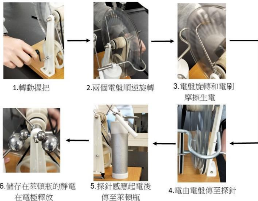
圖 2 韋式起電機起電原理
