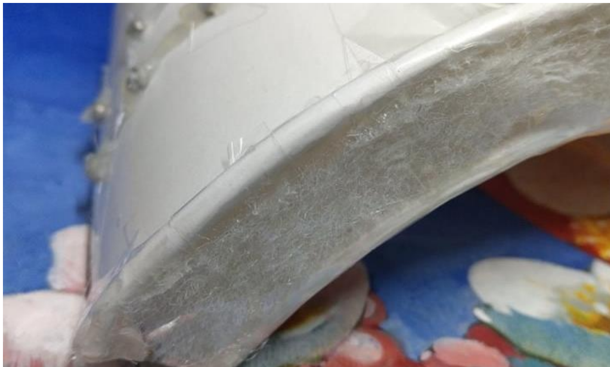
圖十六：NZVI 強磁+海綿過濾管截面模型
