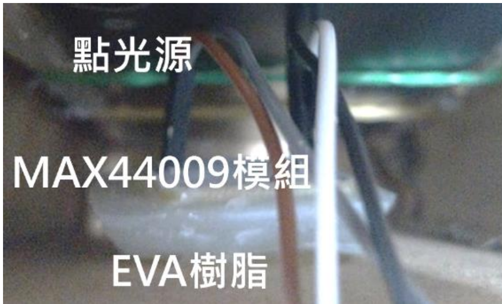
圖十四：測試用光度計模組 (圖十四資料來源：研究者拍攝)
