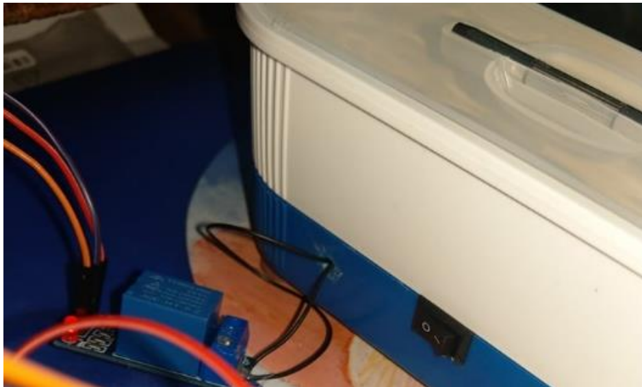
圖十五：測試用超音波震盪儀模組 (圖十五資料來源：研究者拍攝)
