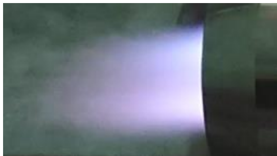
圖3-15、第二代軸向注入型引擎之噴嘴尾焰 圖3-16、第三代軸向注入型引擎之噴嘴尾焰
