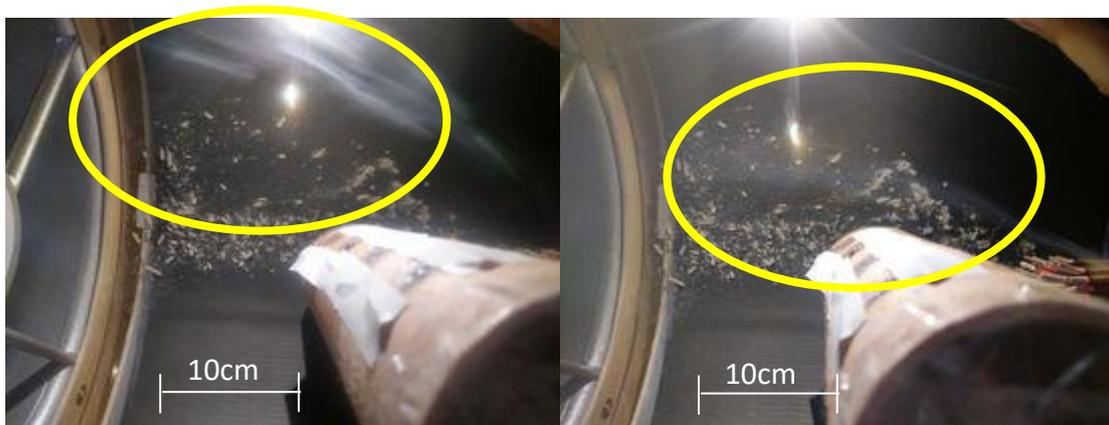
圖十五、線香煙有無抽氣圖(右圖為抽氣過後氣流較貼近圓柱)
