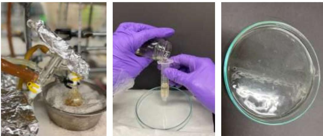
圖十、合成類玻璃高分子步驟：減壓蒸餾下聚合、交聯，加入 HDI 後過濾滴膜
