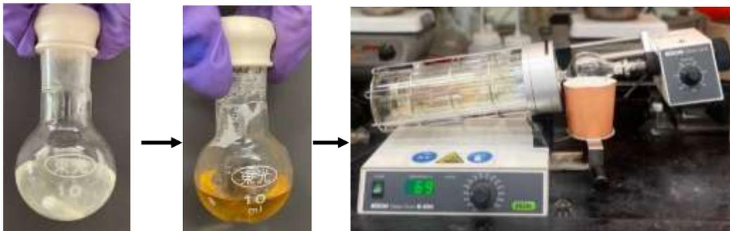
圖十三、從降解前到完全降解後的外觀變化、最後用 Kugelrohr 純化分離產物
