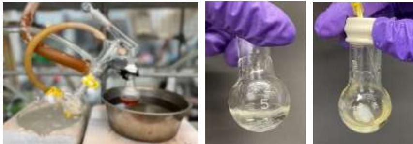
圖六、純化及回收再降解，最右圖為回收完全降解後的外觀
