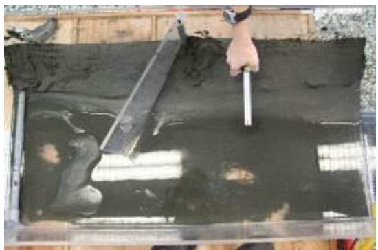
圖 4-39 70 度壩堤實驗後堤後侵蝕測量
