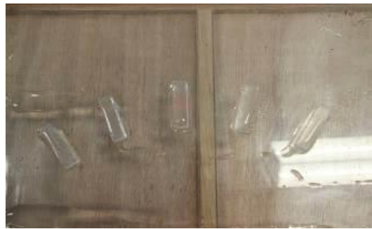
圖 3-2 控制壩堤角度小壓克力塊
