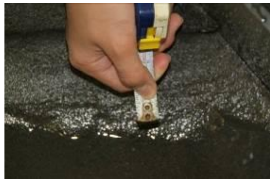
圖 4-51 120 度壩堤實驗後堤後侵蝕測量
