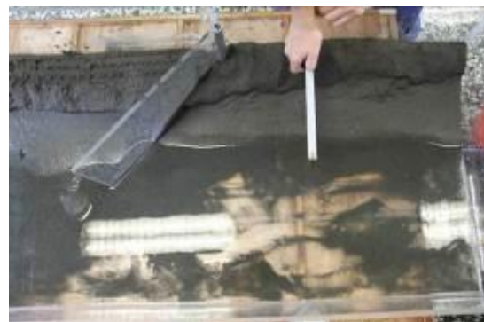
圖 4-35 50 度壩堤實驗後堤後侵蝕測量
