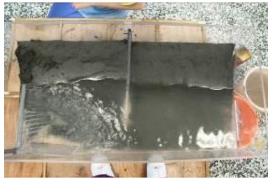
圖 4-41 90 度壩堤實驗中
