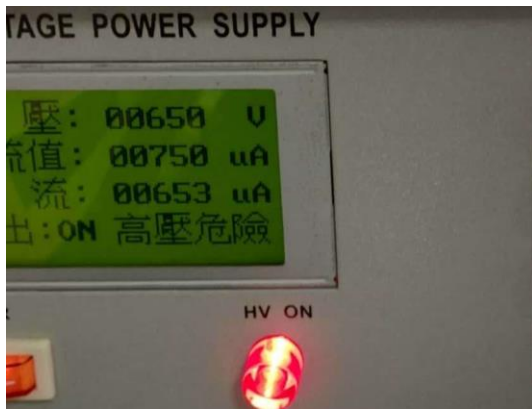
圖5-20、鐵氟龍加電壓前電流
