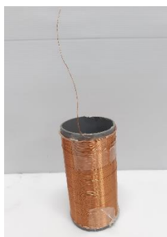
步驟 2-2 直徑 7cm 管長 15cm 的 PVC 螺線管
