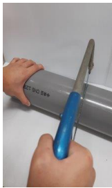
步驟 1-2 鋸開柔軟的 PVC 管
