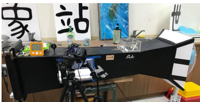
圖十八：以風速計測量風洞各點風速
