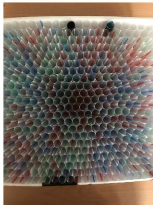
圖十五：自製風洞整流段採用 Honeycomb Type C 的整流段設計
