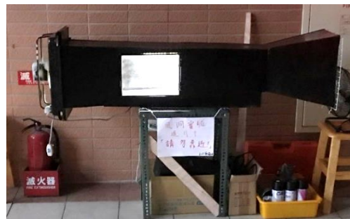
圖十三：自製實驗用風洞
