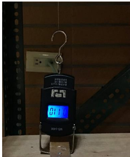
圖廿七：拉力計測量方式
