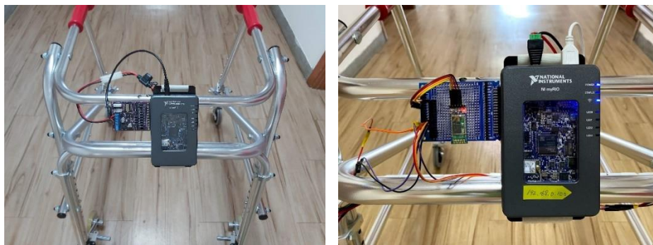
圖十七、myRIO 運算平台架設在市售助步車
