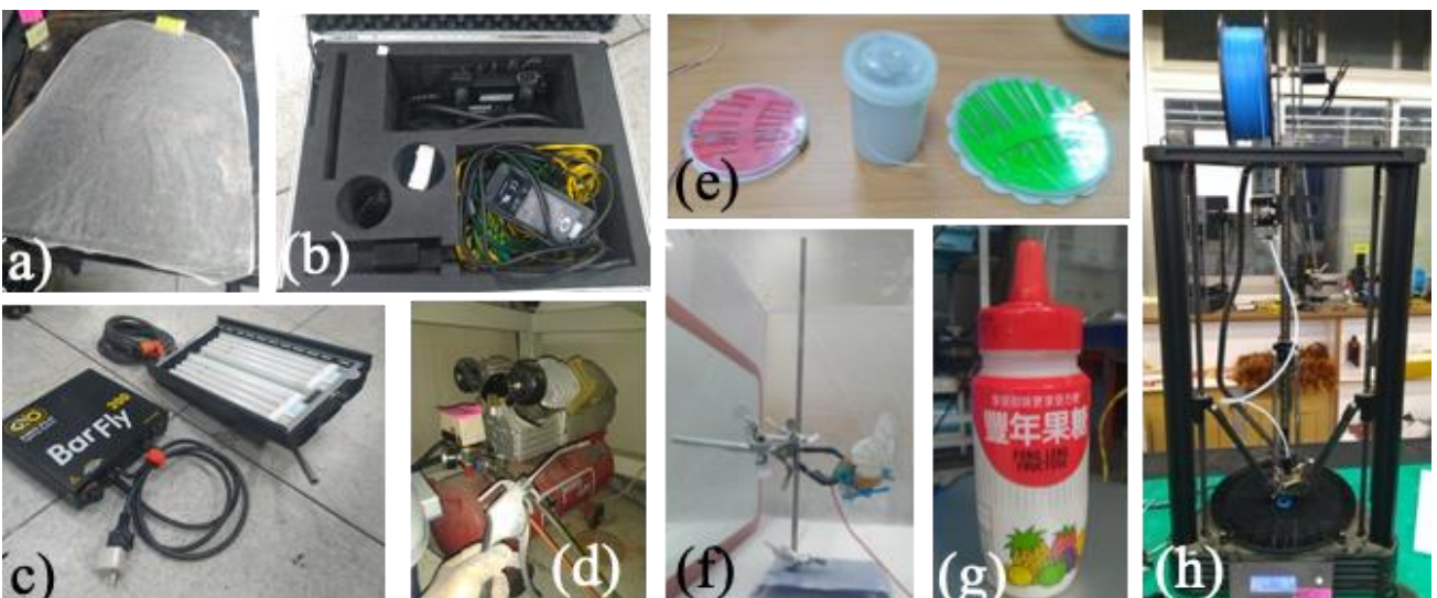
圖三：(a)紗網 (b)高速攝影機之配件 (c)光源 (d)空氣壓縮機 (e)針 (f)鐵架、夾具與拍翼機 (g)果糖 (h)atom 3D列印機
