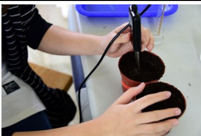
圖 5 土壤水分感測器~乾旱
