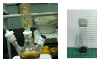
圖2-2 晶體在底部析出 /黑色晶體照片
