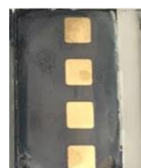
圖2-3蒸鍍完成後之太陽能電池
