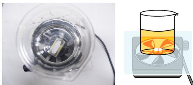
圖 5-5 攪拌機儀器完成圖及示意圖
