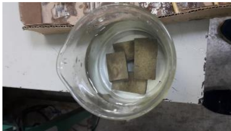
圖(三十六) 整齊放入震盪機中除去細微顆粒
