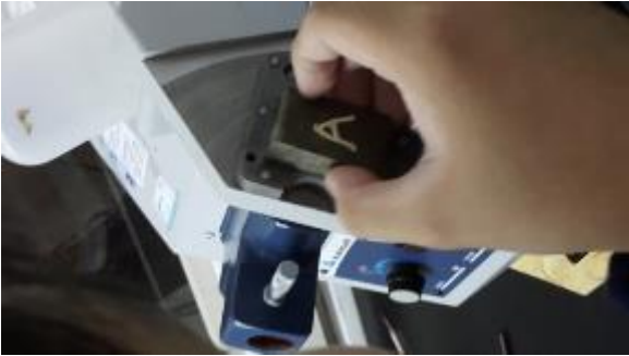
圖(四十一) 以真空吸力吸住蓋玻片
