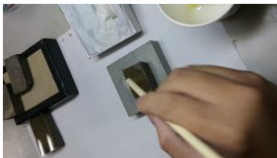
圖(三十九)將 AB 膠塗抹於觀察面上
