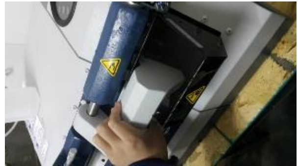
圖(四十四) 以金剛盤磨樣本至 100 微米
