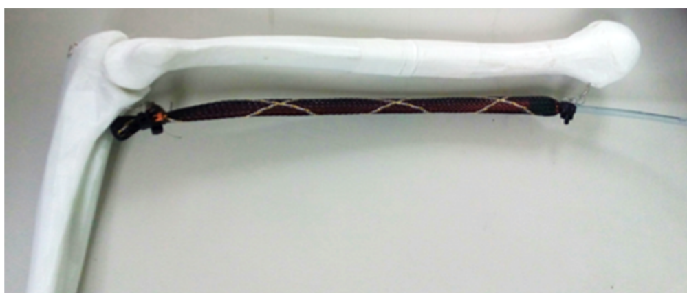
圖 8 氣動肌肉缸固定肌肉於骨骼的情況
