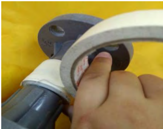
圖 33 本組在改變線軸內外徑時，使用油漆用膠帶(黏性較小)，纏繞在線軸的內徑上，並用游標尺測量，改變線軸的內外徑比。 在製作時，本組從最粗的內徑開始測量，並於縮小內徑(撕膠帶)後，加上紙黏土(對稱黏在線軸上)，以控制線軸重量這變因。
