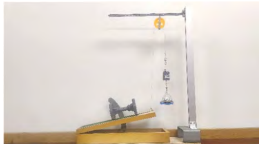
圖 41 將接觸面抬起到線軸滑落動並利用 Tracker 分析角度，求出值，代入 \tan \theta \theta = (\text{值} * 180) / \pi
