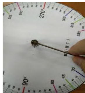
圖 28 轉動微調升降裝置，控制線軸轉動
