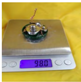
圖 27 測量秤盤及砝碼重量(即為拉力)
