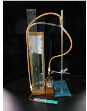
圖五：表面張力測量裝置
