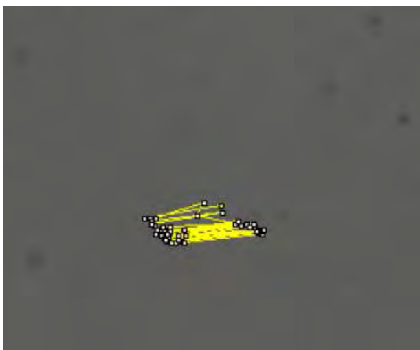
圖三、直徑 650 奈米的氧化鐵粒子在電場 60000N/C 下的運動情形
