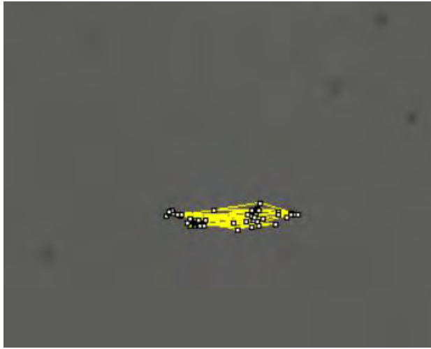
圖一、直徑 650 奈米的氧化鐵粒子在電場 40000N/C 下的運動情形
