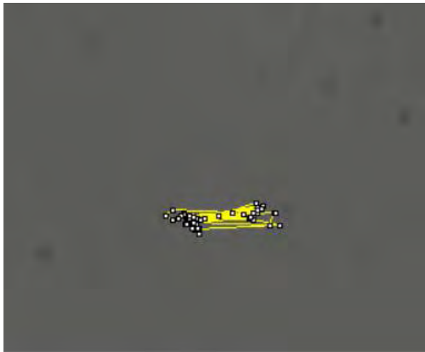
圖二、直徑 2000 奈米的氧化鐵粒子在電場 40000N/C 下的運動情形
