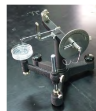
圖三：表面張力測定儀
