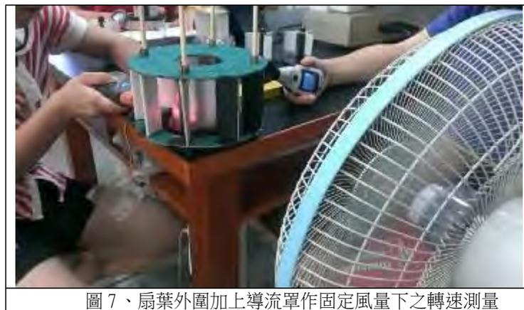
圖 7、扇葉外圍加上導流罩作固定風量下之轉速測量
