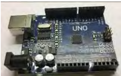
圖 52 arduino，控制光感應器，可接上電腦分析數據或是右圖之顯示面板進行記錄
