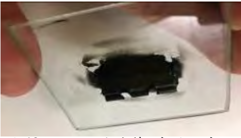
圖 48 上方之玻璃蓋，夾子可夾住鈦片並使其成直立狀，和紫外燈管平行，兩側皆可照射到紫外光
