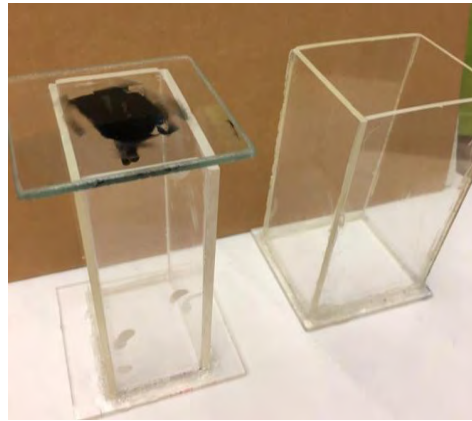
圖 49 裝置內部壓克力反應槽，可注入汙染物並照射紫外光進行降解
