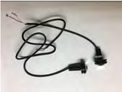
圖 50 裝於黑盒子內下側的 LED 燈本裝置是藉由光穿透度的改變換算成濃度的變化再進行記錄
