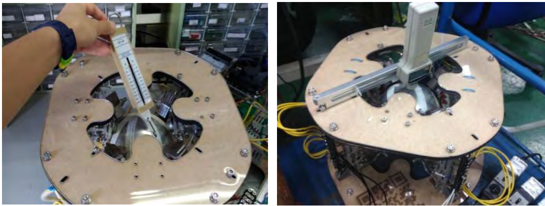
a) 以拉力計進行的摩擦轉矩量測
