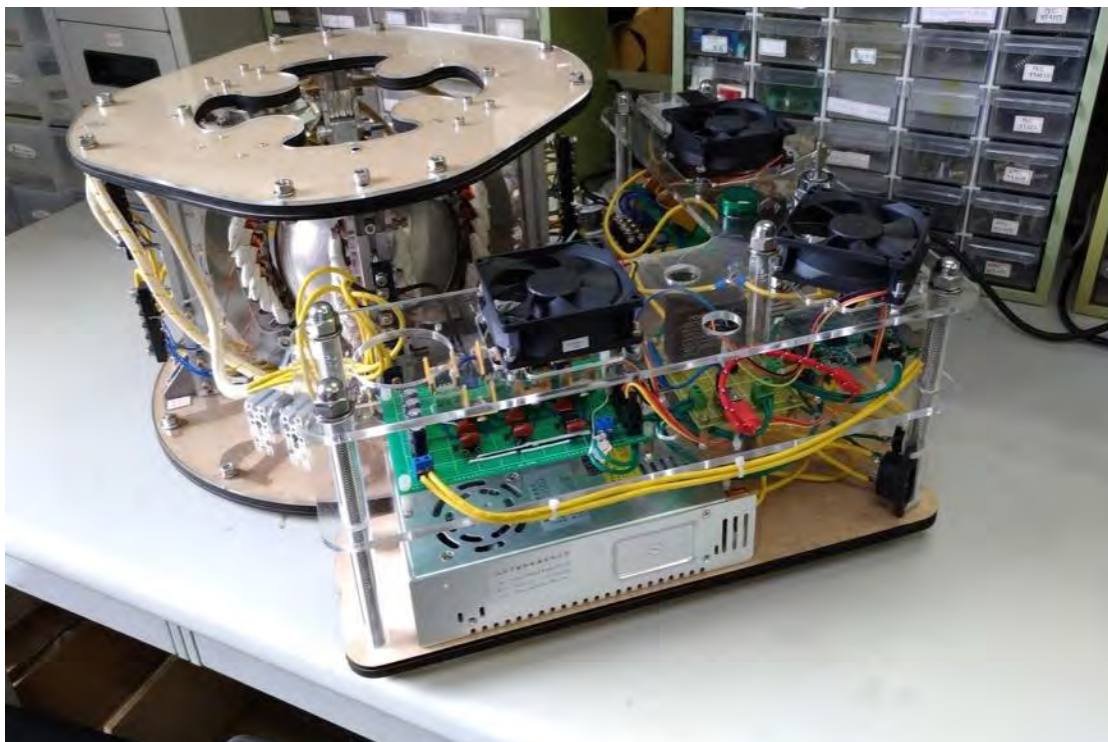
Figure 2: 作品實體圖- 本研究所設計、製作的球型感應馬達本體與驅動器
