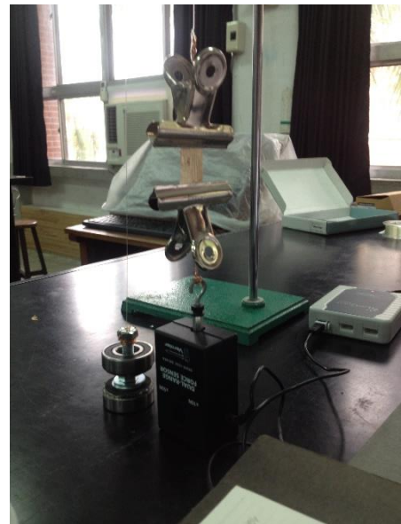
圖十一、改良後的黑棘蟻( P. dives )非蟻繭蟻絲膜延展性實驗配置。
