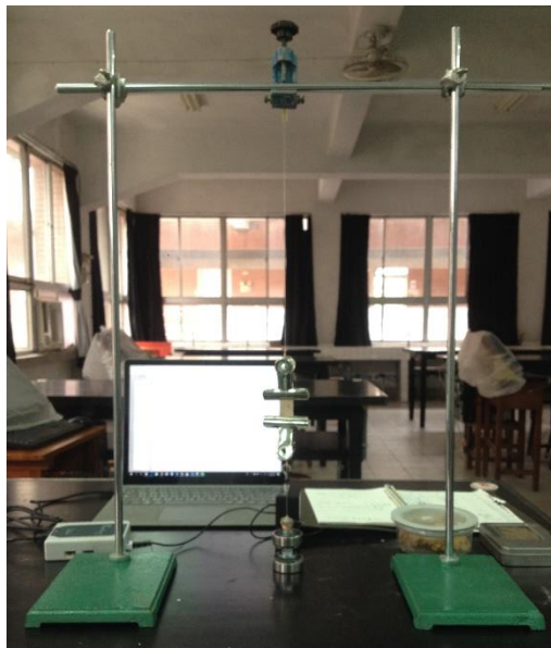
圖十一、改良後的黑棘蟻( P. dives )非蟻繭蟻絲膜延展性實驗配置。
