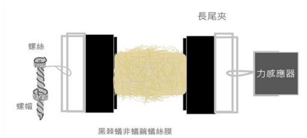
圖十、檢測黑棘蟻非蟻繭蟻絲膜延展性之裝置示意圖
