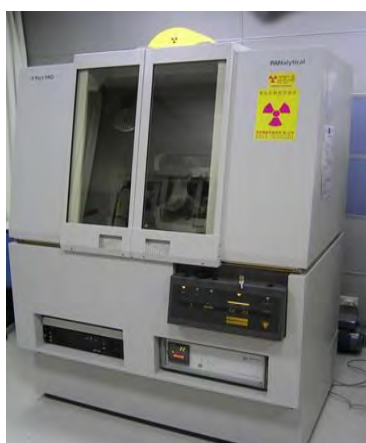
圖 5(A). X-射線繞射分析儀外觀; 圖 4(B). 內部構造示意圖
