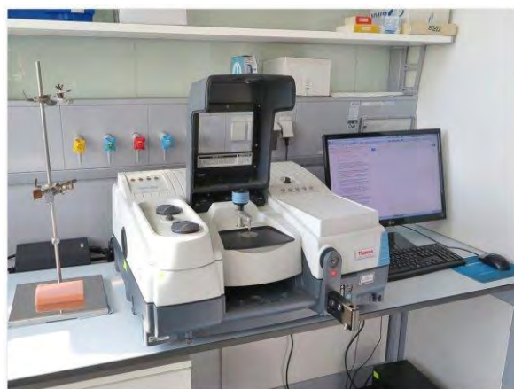
圖 6(A). 傅立葉轉換紅外線光譜儀外觀; 圖 6(B). 內部構造示意圖
