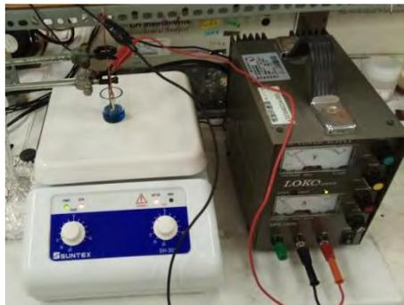
Figure 3 電沉積電極連接圖。
