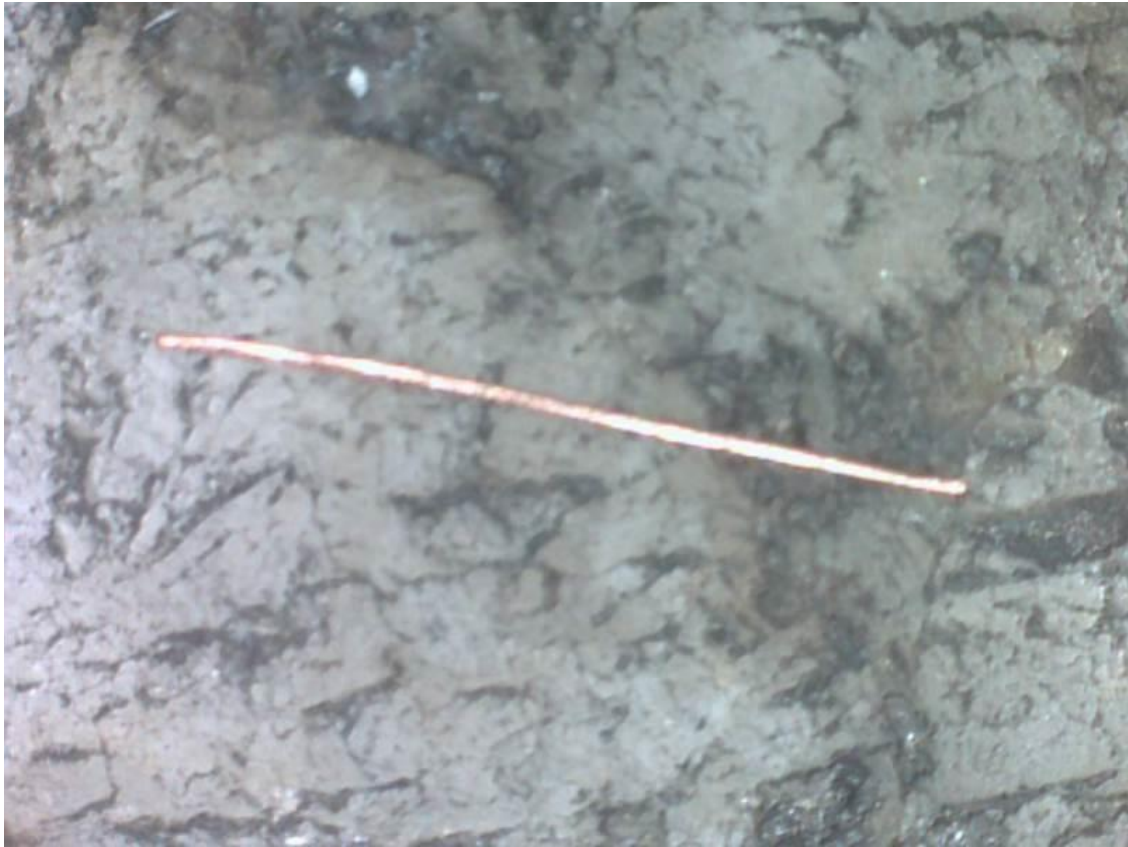
圖五 數位顯微鏡底下的礫岩顆粒與針鉸 對照的銅線長度為0.5cm，粗細為0.11mm/mx50c
