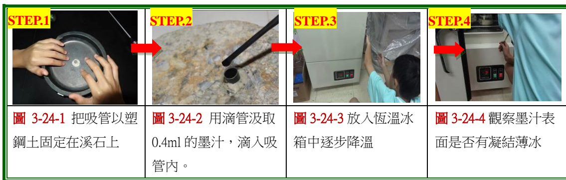
圖 3-24 觀測溪石上墨汁的凝固點
