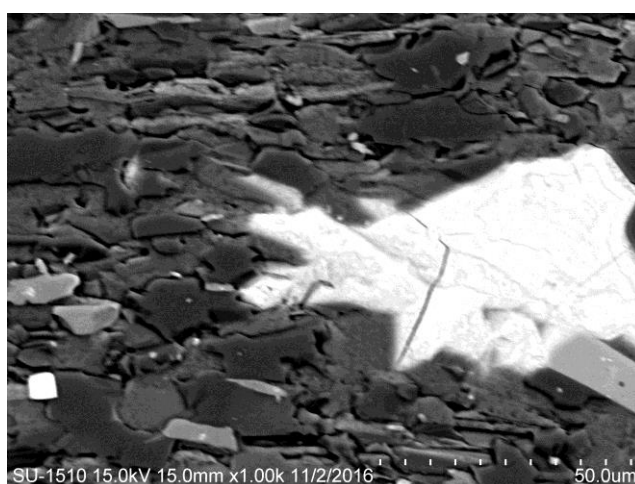
圖 4-8-2 SEM 底下放大 1000 倍的螺溪石礦物組成
