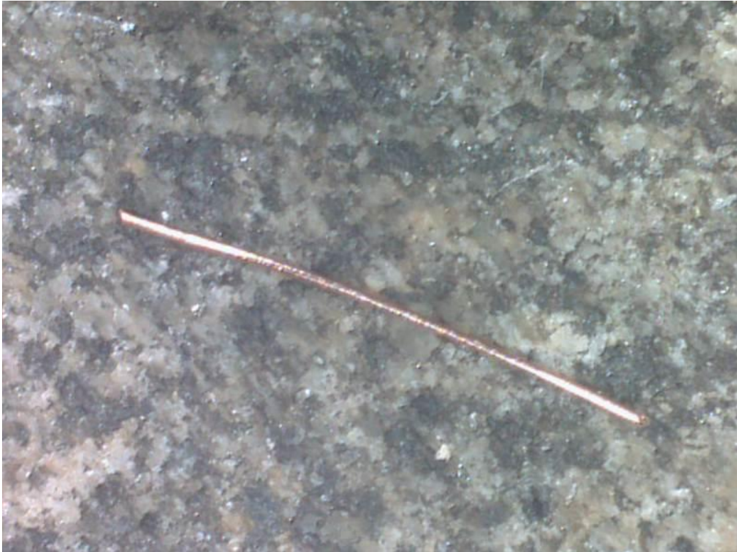
圖三 數位顯微鏡底下的砂岩顆粒與針鉸 對照的銅線長度為0.5cm，粗細為0.11m/mx50c
