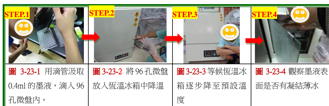
圖 3-23 萃取不同溪石所磨製的墨液，測量結冰時的環境溫度
