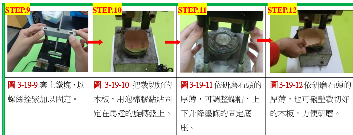
圖 3-19 自製研磨器的製作與組裝流程
