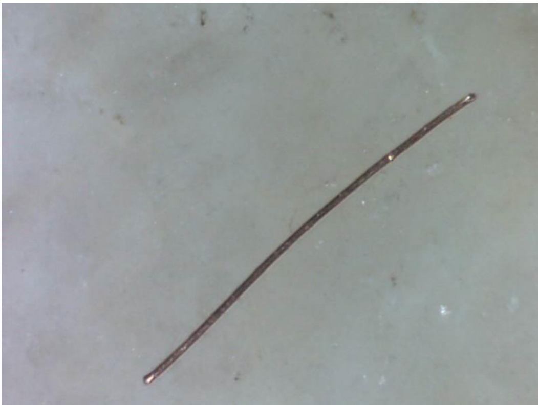
圖四 數位顯微鏡底下的石英岩顆粒與針鉸 對照的銅線長度為0.5cm，粗細為0.11m/mx50c
