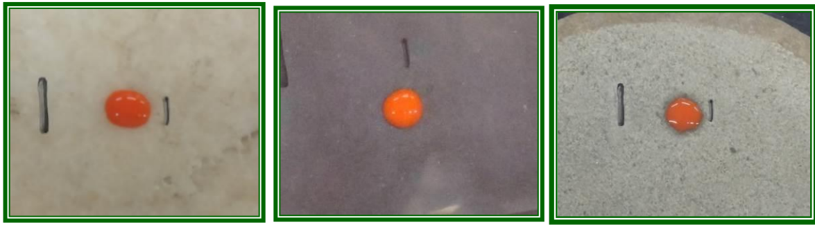
圖 4-14 水珠在溪石上的擴散情形
