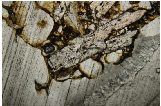
圖 5-12 偏光片下的灰色浮石之斜長石(x100)
