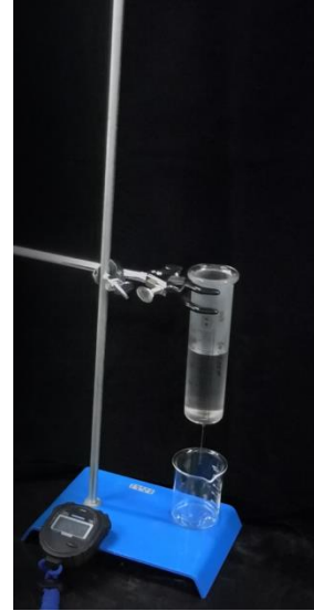
圖五:測量黏滯係數的裝置。
