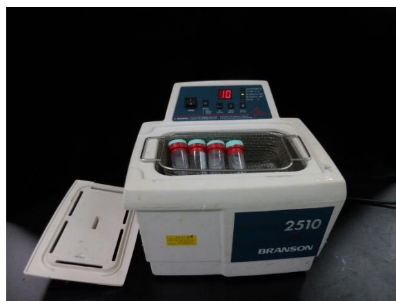
圖一:裝氣體水溶液的試管放置在超音波洗淨儀內振動，製成奈米氣泡水溶液。
