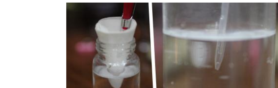
圖 15：以微量吸管吸取飽和食鹽水溶液, 吸取過程有過濾 (左) 與無過濾 (右) 的差別
