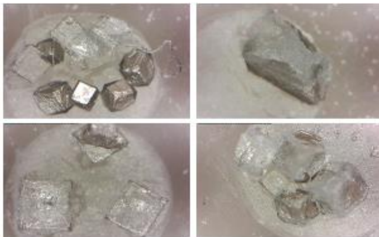
圖 61: 高電壓平行電場下,食鹽晶體碎裂程度不同的比較
