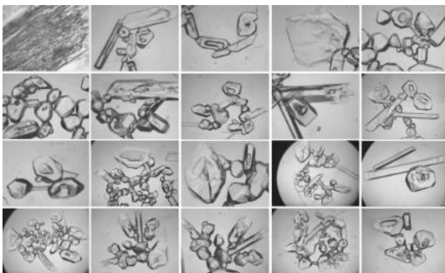
圖 56：顯微鏡下，施加高電壓平行電場（電壓=4850 伏特）的硝酸鉀液滴晶體成長影像
