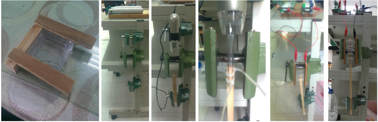
圖 01：第一代到第三代平行板電場裝置與觀察攝(錄)影裝置設計的演變過程
