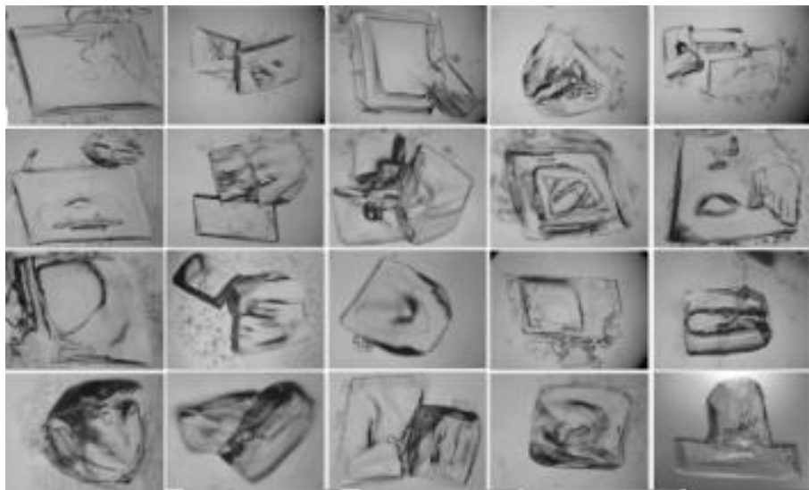
圖 53：顯微鏡下，施加高電壓平行電場（電壓=4850 伏特）的硝酸鈉液滴晶體成長影像
