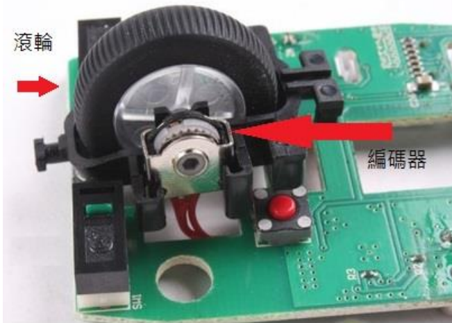
圖 4-6(a)、滑鼠滾輪機械式編碼器連接架構圖
