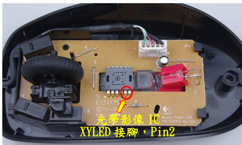
圖5-3、光學滑鼠內光學影相感測IC實體圖
