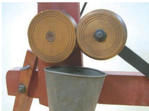
圖 4-14、木製摩擦輪的裝置
