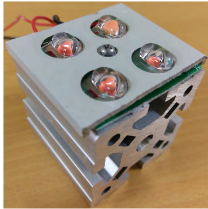
(圖六) 正方塊狀的保護蓋與 LED 組裝成積木式植物生長燈
