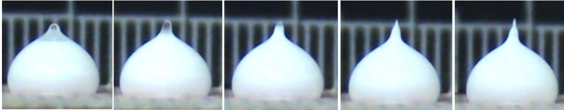
圖二十四:2m 氯化銨水溶液先凝固成煙囪型，煙囪中再長出圓錐形
