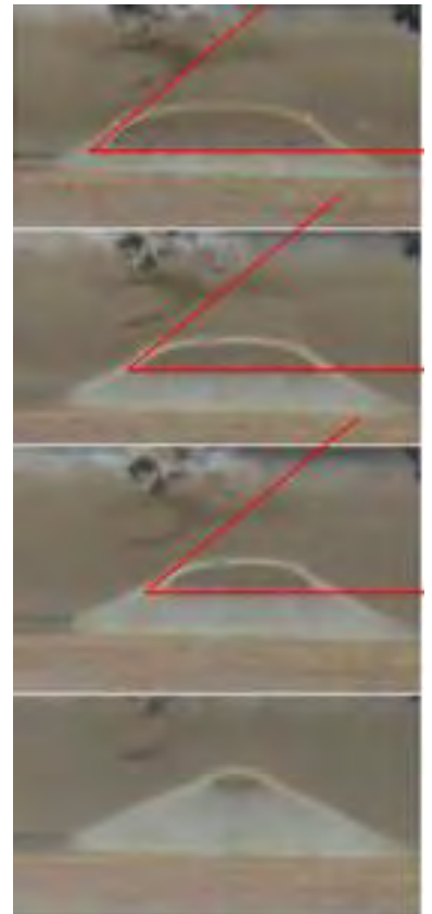
圖十四:同一濃度的乙醇水溶液凝固時，接觸角不隨高度改變
