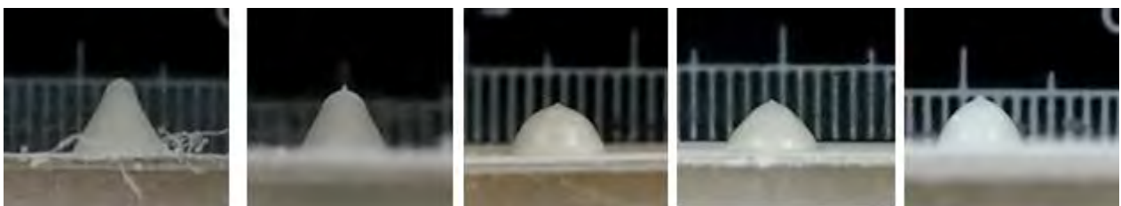
圖十二:乙醇水溶液凝成的冰錐，溶液濃度由左至右依次為 0.75m,1m,1.5m,2m,3m
