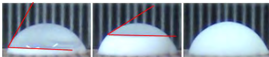
圖二十三:3m 的氯化銨水溶液凝固時接觸角漸小
