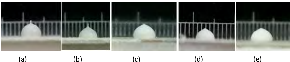
圖十九: (a)至(e)依次為 0.75m，1m，1.5m，2m，3m 的氯化鈉水溶液凝固形成的冰錐，(a)，(b)頂端為煙囪狀，(c)(d)為圓錐狀，(e)圓弧形
