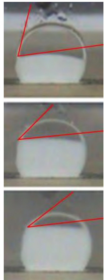
圖十七:同一濃度的葡萄糖水溶液凝固時，接觸角隨高度遞減
