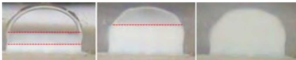
圖二十:3m 氯化鈉水溶液在 Hele Shaw Cell 內的凝固過程
