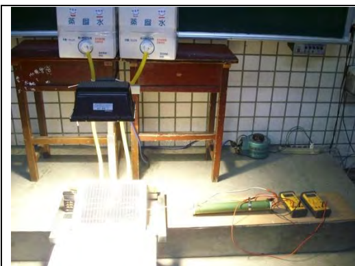
圖 3-7 正面水冷裝置
