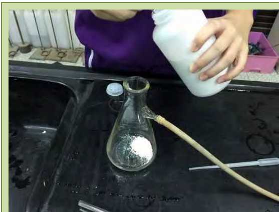
(\text{CaCO}_3 + \text{HCl}) 分解成 \text{CO}_2
