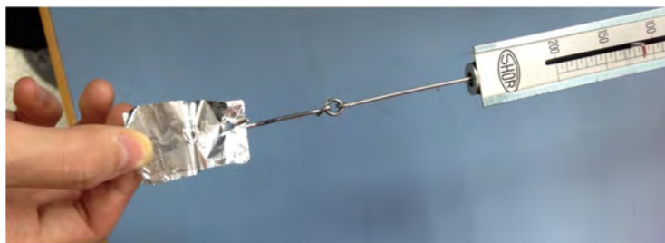
圖 5-3-3 多層鋁箔被撞擊後“黏在一起”的現象
