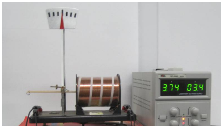
圖 8 通電後與砝碼達成平衡
