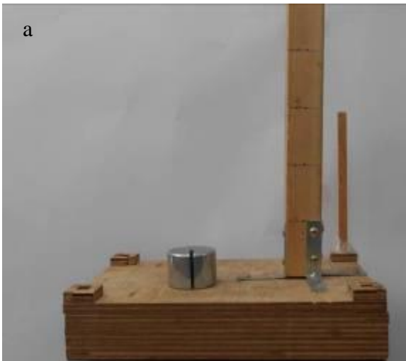
圖 11 a：單擺支架與 0.5 公斤砝碼靜置於震動台當對照組(砝碼未掛上支架)，控制固定質量效應
