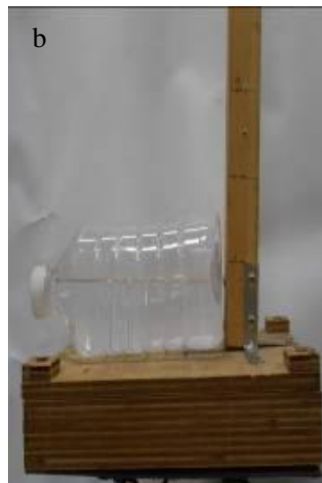
圖 12 b：橫置 1.0 公升寶特瓶，內裝 0.5 公升自來水，與單擺支架共同置於震動台上(組 II)
