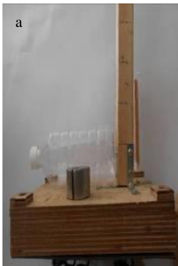
圖 12 a：單擺支架、橫置 1.0 公升寶特空瓶外置 0.5 公斤砝碼於震動台，控制固定質量效應(對照組/ 組 I)
