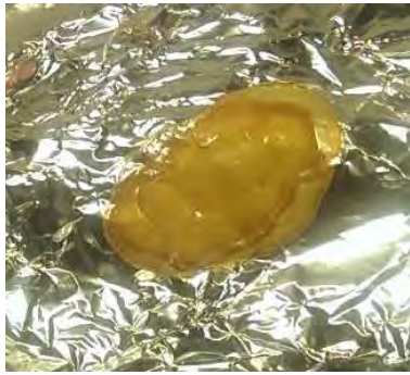
【圖 83】 \text{Fe}(\text{NO}_3)_3 樣本明顯可見外圍與內部的褐色顯色
