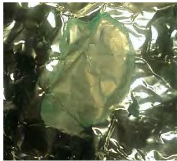
【圖 84】 \text{Cu}(\text{NO}_3)_2 樣本明顯可見外圍與內部的藍色顯色
