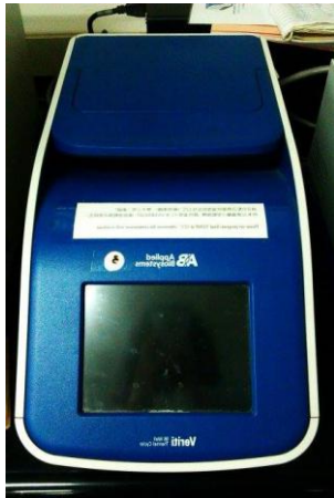
圖 2-7 梯度核酸連鎖反應儀
