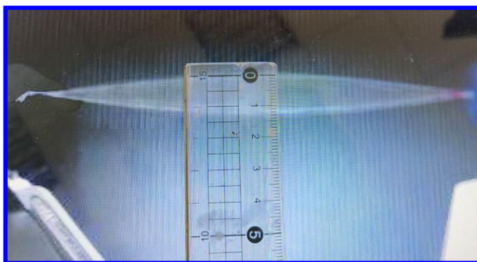
圖 7：去年學姊們用尺在螢幕上量駐波的振幅。
