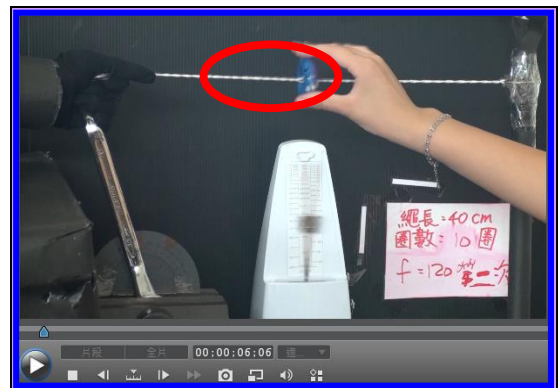
圖 24：轉動風火輪數十圈後，手開始放開時的影像。 說明：繩子已被纏繞成『單股』狀態。
