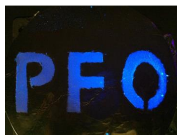
(圖 6) PMMA/PFO 纖維在 UV 下情形
