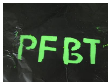
(圖 8) PMMA/PFBT 纖維在 UV 下情形
