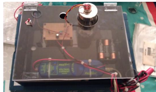
圖 8 CO 偵測器 1 完成裝置圖
