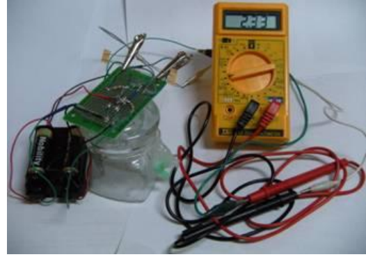
圖 6 CO 偵測器 2 完成(0~1000ppm)
