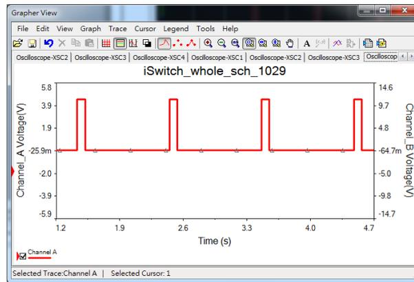
圖 43c 控制電路輸出訊號
