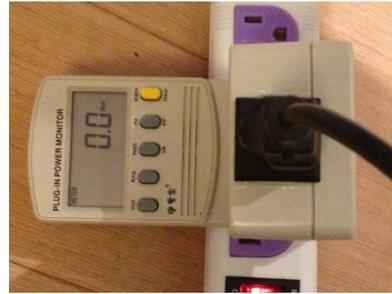
圖 52b 使用智慧型節能開關之待機耗電
