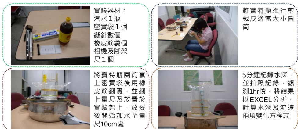
圖 15 家用雨量筒實驗器材及步驟說明圖
